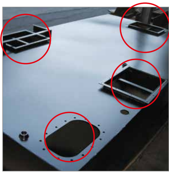
▲ Punti di accesso per l'ispezione e la pulizia
