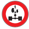
Fig. 69 - 0690 transito vietato ai veicoli aventi una massa per asse superiore a ... ton
