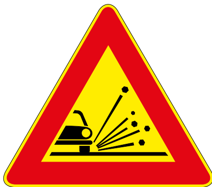
Fig. 390 - 3900 materiale instabile sulla strada
