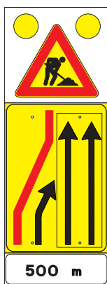
Fig. 399/a presegnale di cantiere mobile
