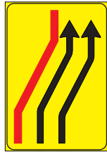
Fig. 411/d - 4116 segnale di corsie chiuse
