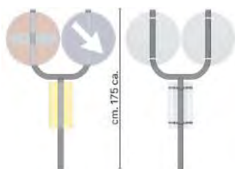
dispositivo aiuole spartitraffico Ø 60 mm
