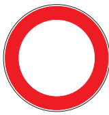
Fig. 46 - 0460 divieto di transito
