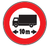
Fig. 67 - 0670 transito vietato ai veicoli o complessi di veicoli aventi lunghezza sup. a ... m
