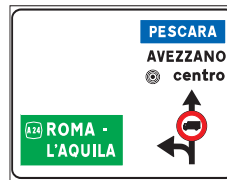
Fig. 239 segnale di preavviso di intersezione urbana, con divieto di transito per una categoria di veicoli su un ramo dell'intersezione
