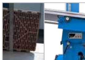
Taglio inclinato su mattoni con cavità vuote
