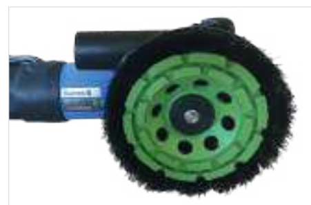
Utilizzabile anche con platorello diamantato. Con platorello usare velocità 4-5.
