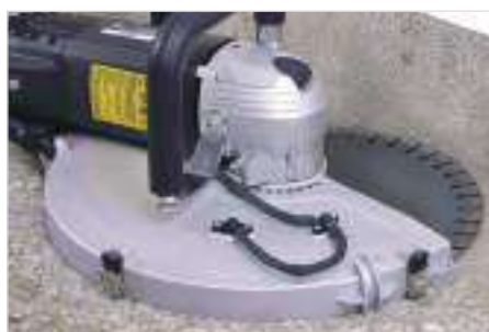
Protezione lama rimovibile senza utensili per il taglio a filo con disco e kit di taglio a filo (vedi accessori)
