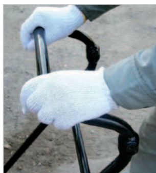
Impugnatura con dispositivo VAS
