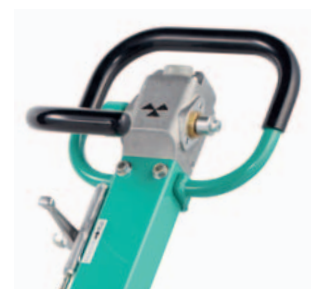
Dispositivo idraulico a leva singola per l'avanzamento e la retromarcia.
