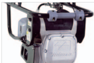
Maniglia ergonomica con roll bar
