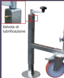
**Stabilizzatori/livellatori a vite** in acciaio zincato con piattello per base rigida sono utili per compensare pendenze o dislivelli fino a 27 cm. con la massima precisione dotati di valvola di lubrificazione per garantire una lunga durata nel tempo
