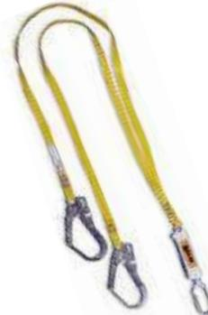
Cordino anti-caduta lungo 2 metri con assorbitore di energia, dotato di moschettone a ghiera CS20 e di doppio connettore in acciaio inox con 63 mm di apertura per l'aggancio a trabattelli con tubi di diametro Ø massimo di 5,5 cm.
