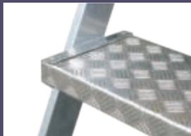
Gradino profondo 200mm realizzato in lamiera mandrolata che garantisce gradini molto robusti con spessore 3mm ed un anti-scivolo alto 2mm particolarmente efficace
