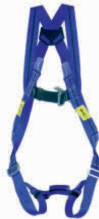
Imbracatura a 2 punti di ancoraggio dorsale, e sternale può essere utilizzata sia su trabattelli che su scale fisse o scale portabili. Realizzato in tessuto poliestere di lunga durata, anello a «D» dorsale in acciaio galvanizzato completamente scorrevole per un maggior confort, fibbie accoppiate su petto e gambe, nastro pettorale da 45 mm in poliammide con fibbia metallica ad apertura rapida. Peso 600 g.
